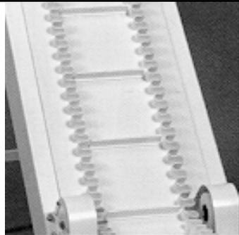
Alle PVC- und einige PU-Transportbänder können mit Längs- oder Querprofilen ausgerüstet werden.
