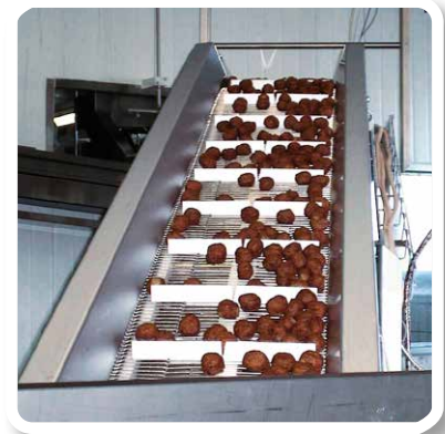
Stabgeflechtband mit Mitnehmern im Betrieb (Steigungstransport von Fleischbällchen)
